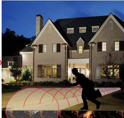
2) Il sistema di cavi **SC2** è composto da un cavo TX e uno RX che vengono interrati paralleli ad una distanza di 2 metri tra loro in modo da formare un campo sensibile alto circa 1 metro e largo circa 3 metri.
